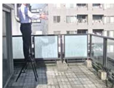
① 10ℓの水を入れた商品を2mの高さから落下させてみます。
